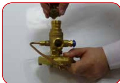
*Монтаж и преднастройка регулятора расхода 4001 и комбинированного регулятора расхода 4006*
