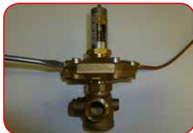
Регулятор перепада давления 4002 FIX TS имеет встроенный исполнительный элемент и может регулироваться с помощью термoeлектропривода двух позиционного или импульсного регулирования. Термопривод в комплект поставки не входит.
