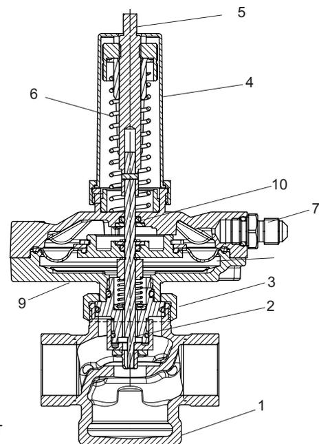
Аммиак, содержащийся в конопляной пакле, повреждает латунные корпуса клапанов. Прокладки из EPDM набухают от минеральных масел или смазок, содержащих минеральное масло, что приводит к выходу из строя прокладок из EPDM. Для использования антифриза и антикоррозионных средств на основе этилена и пропиленгликоля обратитесь к документации производителя деталей.
