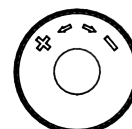
Ручная установка расчетной степени открытия клапана 2K.
