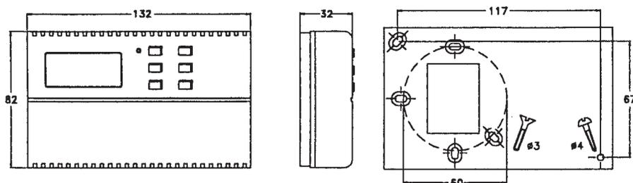
При настенном креплении следите за тем, чтобы от дна корпуса прибора была отделена только та часть, которая специально для этого предназначена. Если полностью отделить перегородку, возникает опасность того, что корпус больше не будет плотно закрываться. Прибор следует монтировать таким образом, чтобы он мог воспринимать среднюю температуру в помещении (следует избегать сквозняков, а также близости окон и дверей). Монтаж должен производиться на расстоянии  $\approx 1,5$  м от пола.
