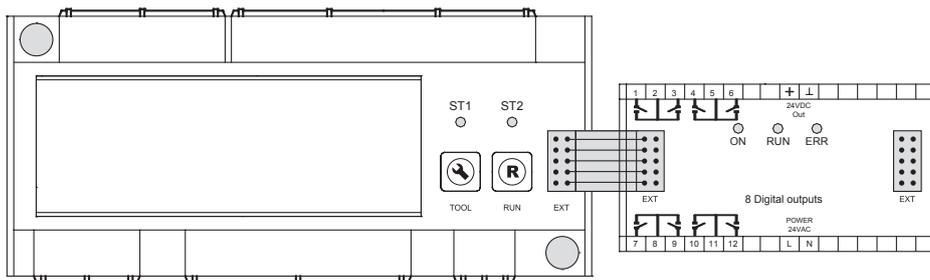
Выходной цифровой модуль устанавливается на 35мм DIN рейку.
