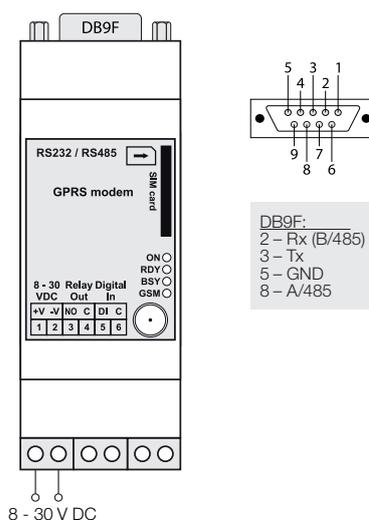
GPRS модуль устанавливается на 35мм DIN рейку. Все модули монтируются друг за другом и в непосредственной близости от микропроцессорного контроллера в порядке, указанном в руководстве пользователя.
