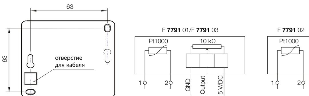
Основание корпуса датчика монтируется с помощью двух винтов диаметром 4 мм через отверстия, расположенные на тыльной части корпуса. Соединительный кабель датчика PP00 2 x 0,75 мм<sup>2</sup> и потенциометра PPU 3 x 0,75 мм<sup>2</sup>, должны быть размещены внутри корпуса через отверстие для кабеля и подключены согласно электрической схеме подключения. Датчик комнатной температуры должен быть установлен вдали от попадания прямых солнечных лучей. Максимально допустимая длина кабеля - 100 метров.
