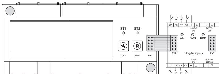
Модуль цифровых входов устанавливается на 35мм DIN рейку.
