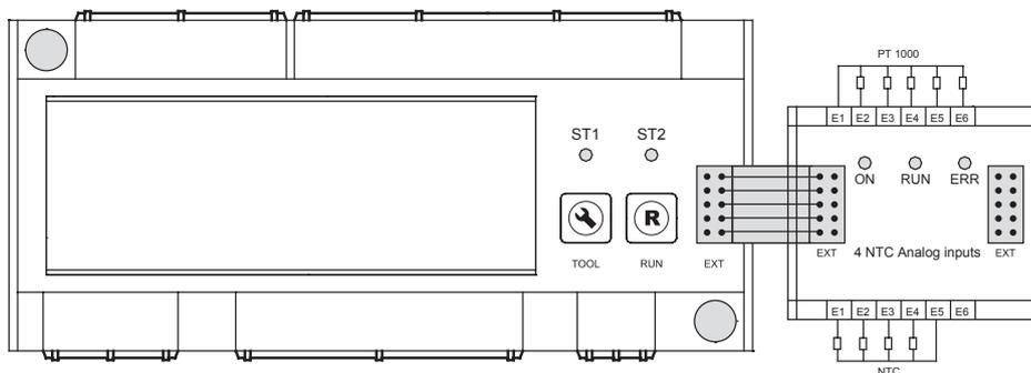
Модуль аналоговых входов устанавливается на 35мм DIN рейку. Все модули монтируются друг за другом и в непосредственной близости от контроллера в порядке, указанном в руководстве пользователя.
