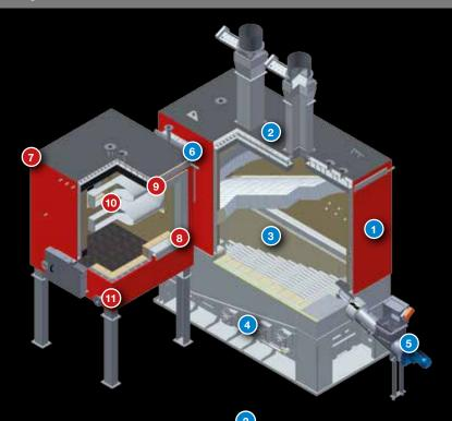
Камера сгорания с водяным охлаждением
