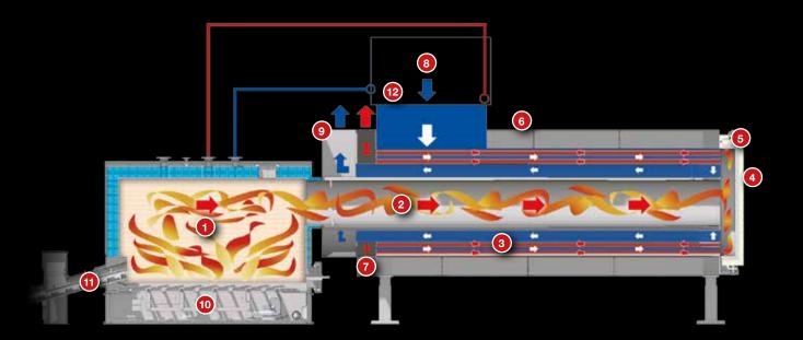
Камера сгорания с водяным охлаждением
