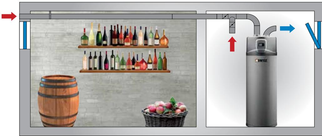
**Всасывание воздуха снаружи здания или внутри одного из помещений - выдувание внутри помещения**
