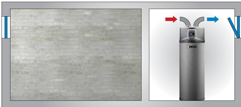
**Всасывание и выдувание воздуха в одном и том же помещении.**
