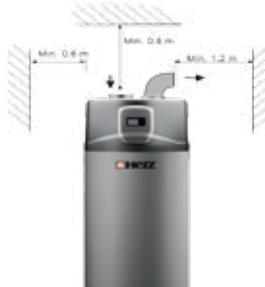
Для WBP 300 необходимо устанавливать отвод трубы с углом мин. 90°, это позволяет избежать перемешиванию всасываемого и выдуваемого воздуха.
