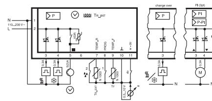
Схема соединений, тип 24 V, 1 7794 24
