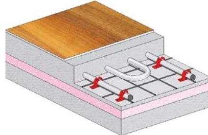
Рекомендуемый интервал между пружинными зажимами 300 - 500 мм,
