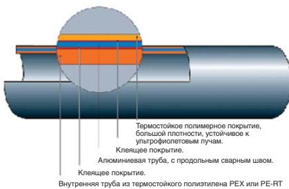
Для внутренней трубы используется специальный PE-RT полиэтилен, с повышенной термостойкостью по стандартам DIN 16 833. При этом речь идет об этиленоктановом сополимере; на основе молекулярной структуры с основной этиленовой цепью и боковой октановой, получается высокая плотность, а также хорошая гибкость и длительная прочность.
