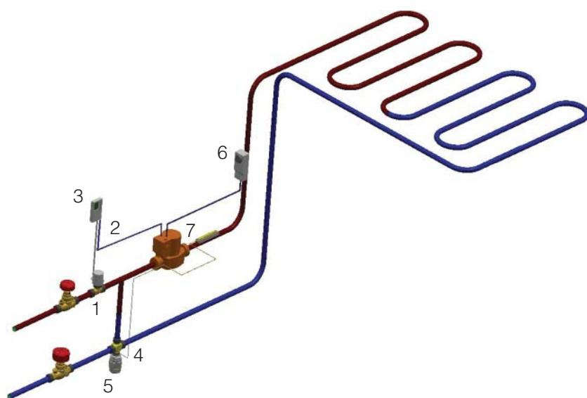
**Регулирование одного или более циркуляционного кольца системы отопления, подключение к радиаторному отоплению, напольному отоплению – набор регуляторов.**
