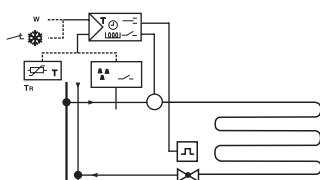
Управление охладительным потоком в двухтрубной системе со сдвигом заданной комнатной температуры, контролем точки росы, внутренним и внешним датчиками температуры.
