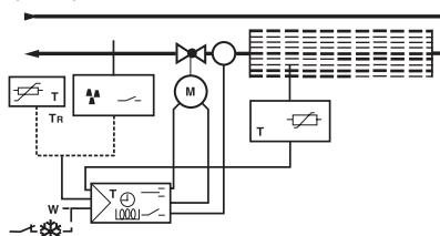
**Регулирование температуры воды в подающем потоке (ступенчатое) для охлаждения, например, фэнкойл. С контролем точки росы и датчиком внешней температуры**
