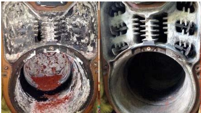
Рис. 1 Результат впливу конденсату, що включає в себе розчин сірчаної кислоти
